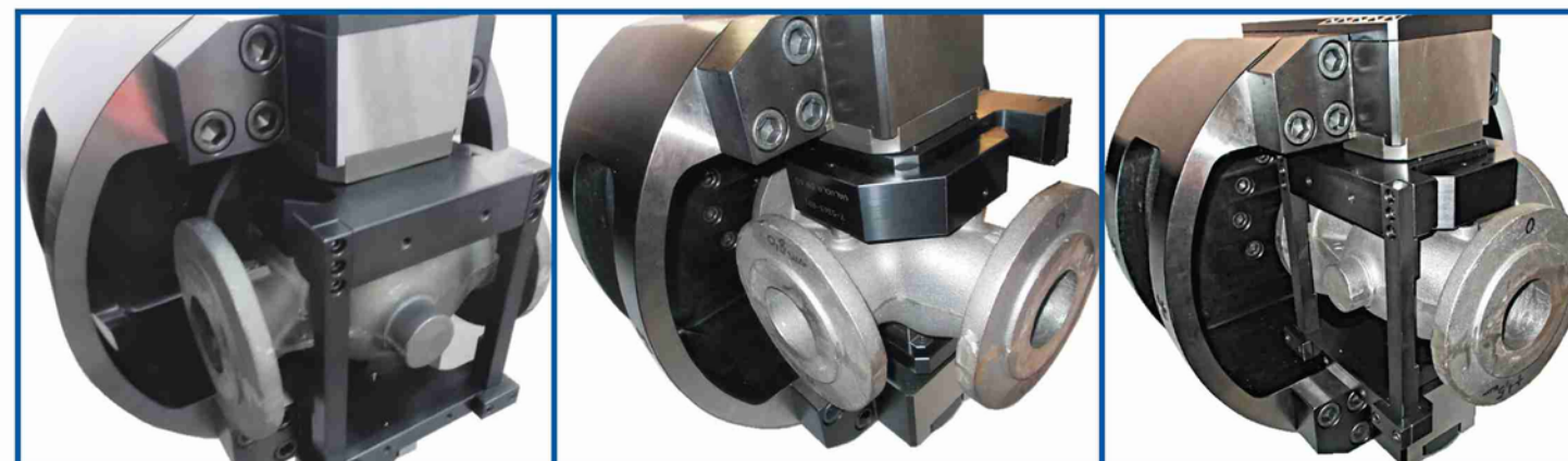
IDRO-P 5/500 - Per lavorazione corpi valvola con 4 posizioni angolari e intercambiabilità con autocentranti MC-ID
