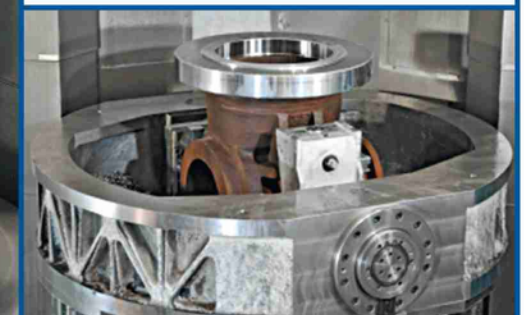
Rotazione di 90°+ lavorazione sul terzo lato
