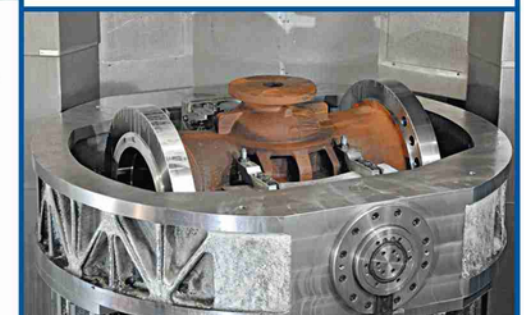
Rotazione di 90°+ lavorazione sul quarto lato
