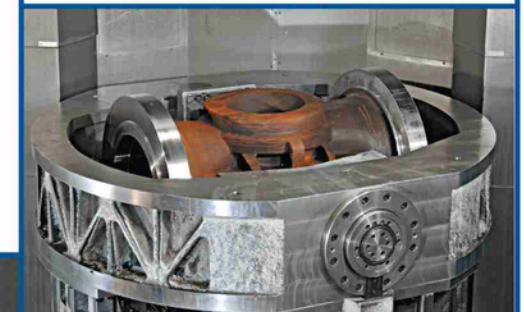
Rotazione di 90°+ lavorazione sul secondo lato
