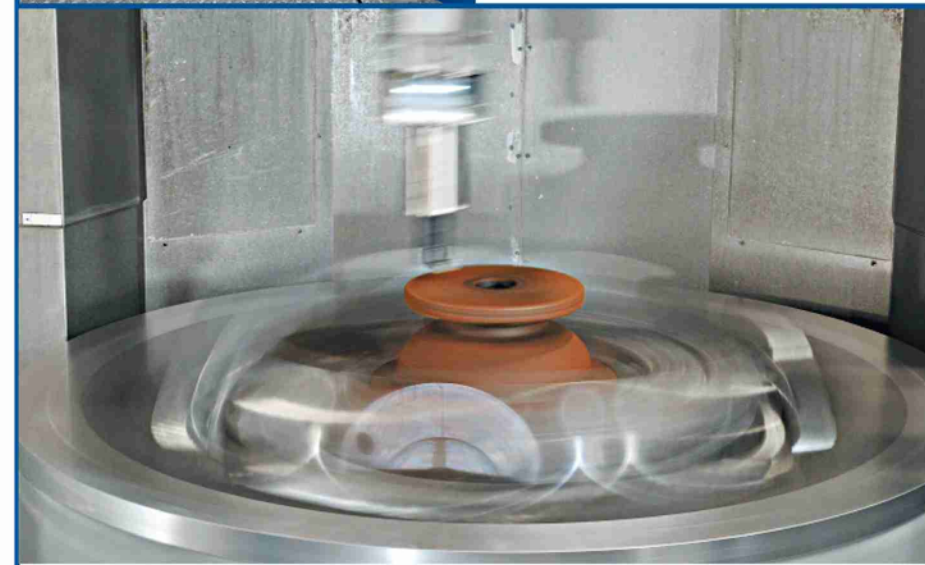
Rotazione di 90°+ lavorazione sul secondo lato
