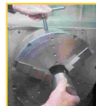
Registrazione radiale continua a mano delle griffe con chiave di registrazione
